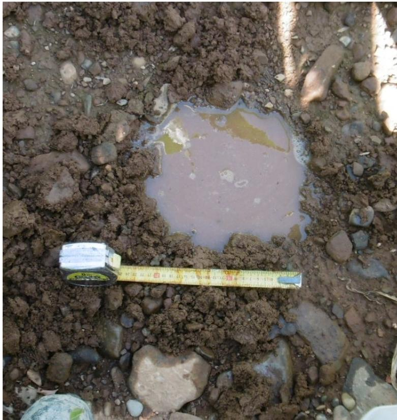
*Prova di permeabilità in pozzetto superficiale K2*
