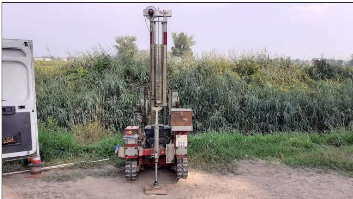
Esecuzione della prova penetrometrica CPT3
