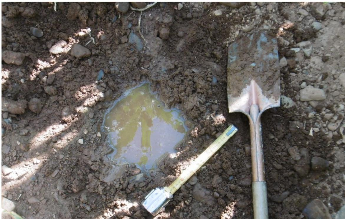
*Prova di permeabilità in pozzetto superficiale K3*
