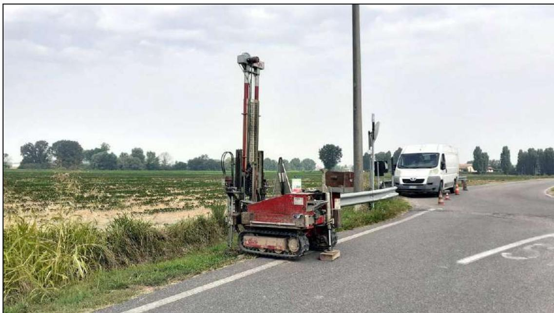
Esecuzione della prova penetrometrica CPT4
