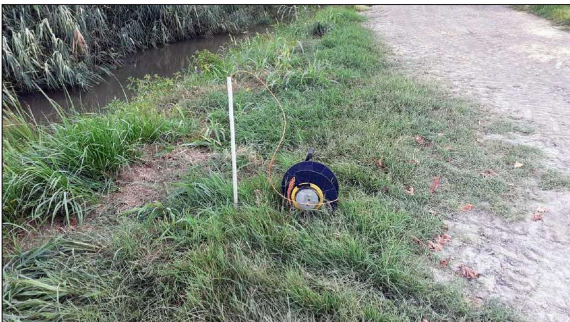
Installazione del micro-piezometro e rilievi freaticimetrici
