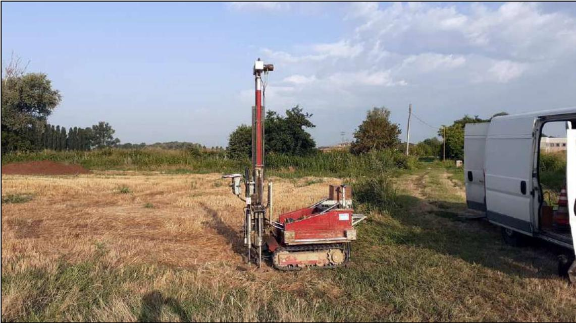
Esecuzione della prova penetrometrica CPT1
