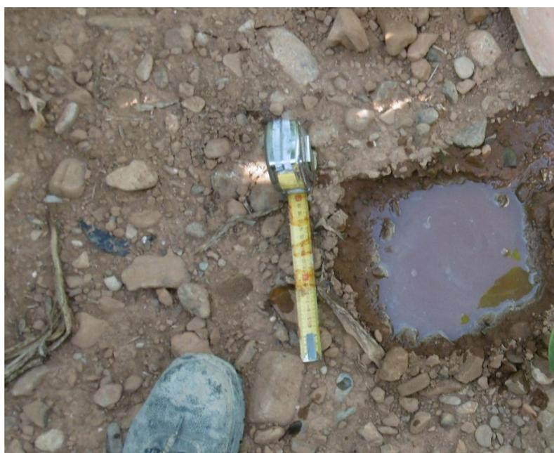
Prova di permeabilità in pozzetto superficiale K1
