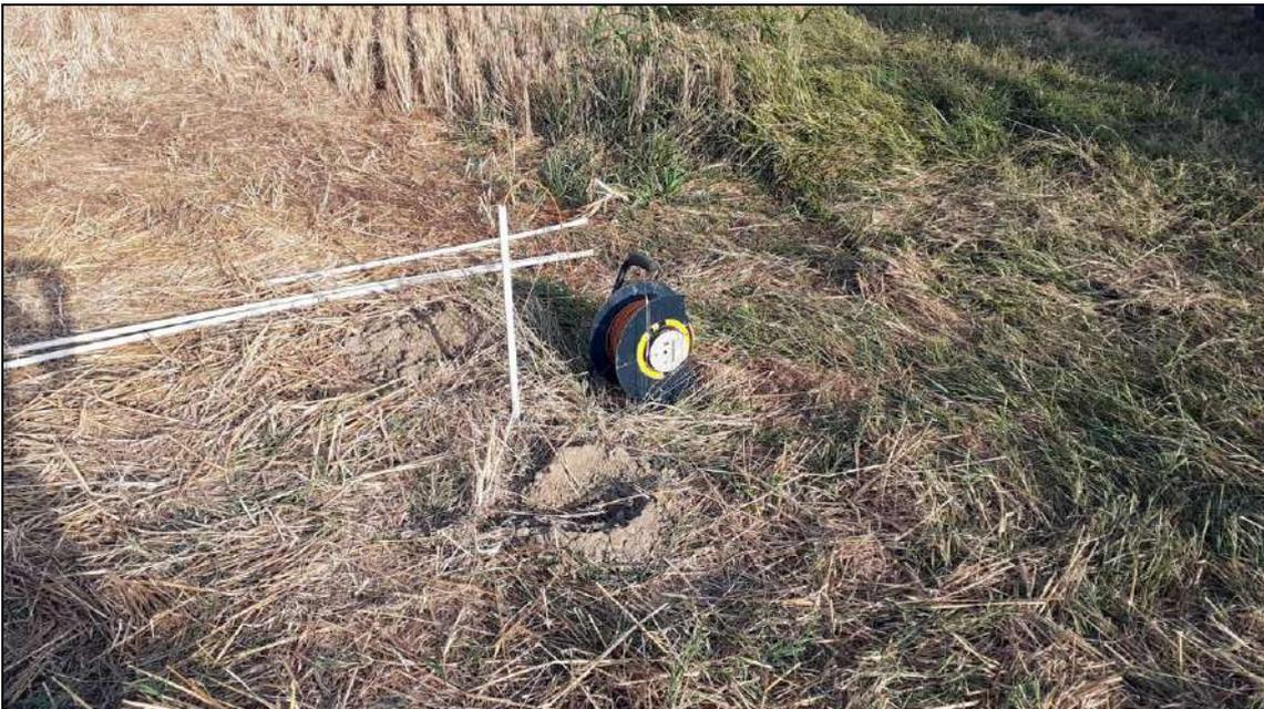
Installazione del micro-piezometro e rilievi freaticimetrici
