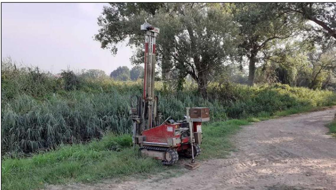
Esecuzione della prova penetrometrica CPT2
