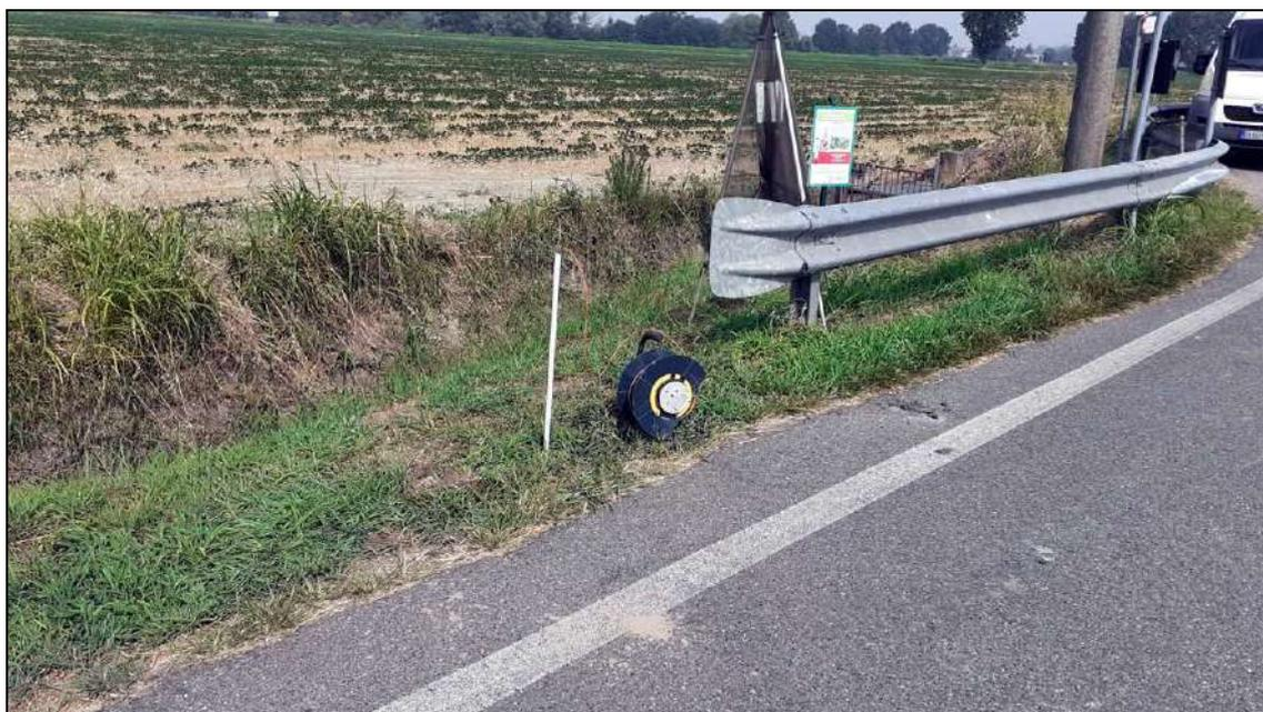
Installazione del micro-piezometro e rilievi freaticimetrici
